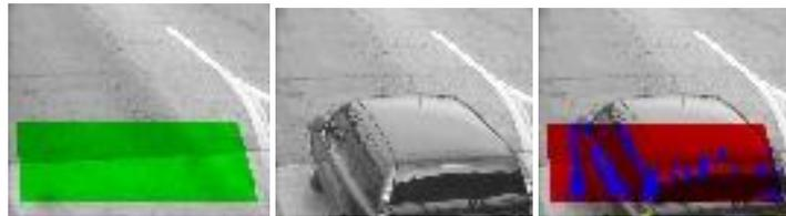
Figura 50 –esempio di veicolo rilevato dal SW EVIVD
