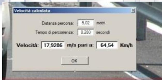
Figura 60 – dettaglio delle risultanze della verifica diretta della velocità
