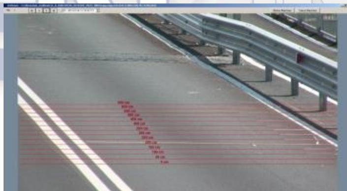
**Figura 55 – Schema rilevamento della velocità dall'anteriore**
